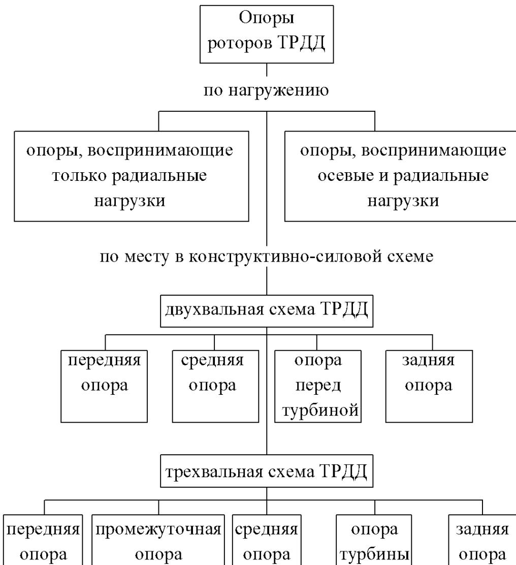
Рис. 1.10. Классификация опор ТРДД
