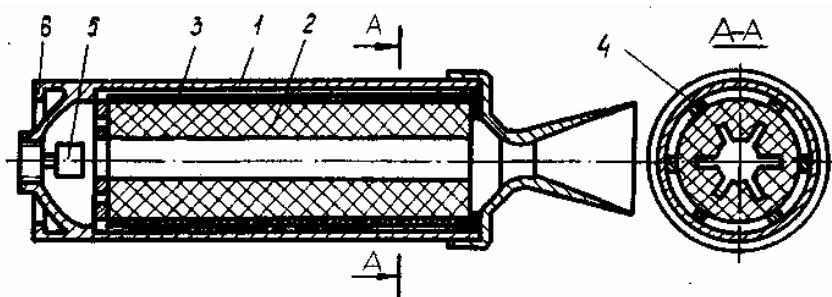
Рис.4.4. Схема РДТТ с вкладным зарядом: 1- корпус; 2 – заряд; 3 – бронирующее покрытие; 4 – вкладыш; 5 – воспламенитель; 6 – узел стыковки
