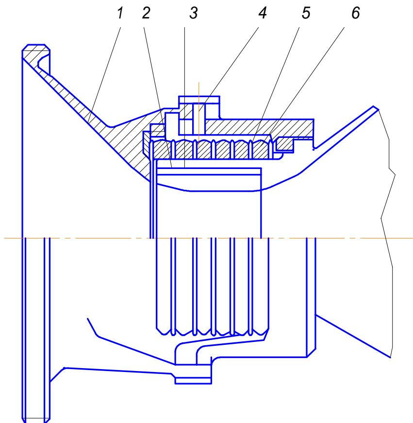
Рис.4.11. Качающееся сопло с простым шарниром и сильфонным уплотнением: 1 – основание сопла; 2 – наконечник сопла; 3 – вкладыш; 4 – ось; 5 – сильфон; 6 – защитные кольца
