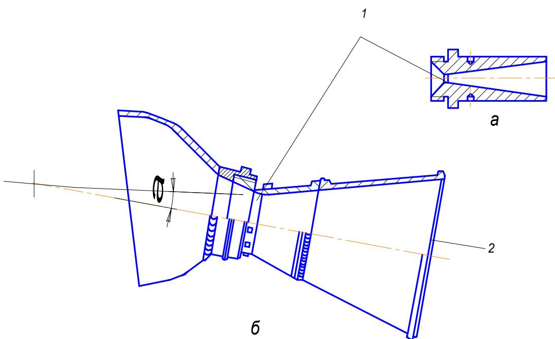
Рис.4.9. Простые сопла РДТТ: а – точеное, б – сварное, установленное под углом к оси двигателя: 1 – цилиндрическая проточка; 2 – заглушка
