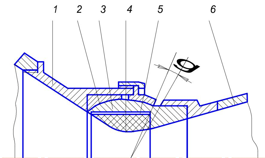
Рис. 4.10. Качающееся сопло со сферическим шарниром: 1 – основание сопла; 2 – под пятник; 3 – сферический наконечник; 4 – вкладыш; 5 – теплоизолирующий слой; 6 – сверхзвуковая часть сопла
