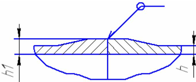
Рис. 4.6. Стыковое сварное соединение с усилением кромок
