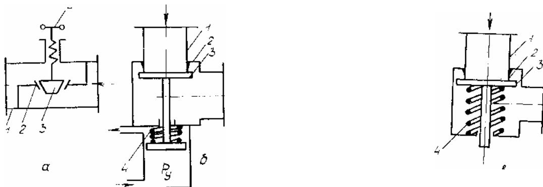
Рис. 2.1. Виды клапанных устройств: а- с ручным; б- с дистанционным управлением; в – автоматическое; 1 – корпус; 2- седло; 3- запорный орган; 4 — привод
