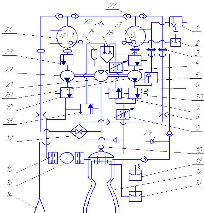
Рис.1.2. Пневмогидравлическая схема ДУ без дожигания
