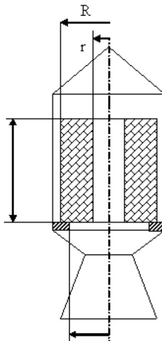
Рис. 4.13 . Расчетная схема при расчете на прочность вкладного заряда
