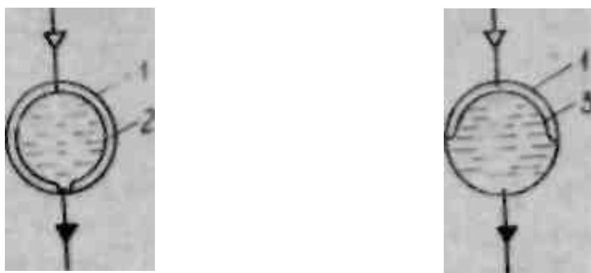
Рис.1.11. Вытеснение компонентов из бака в невесомости
