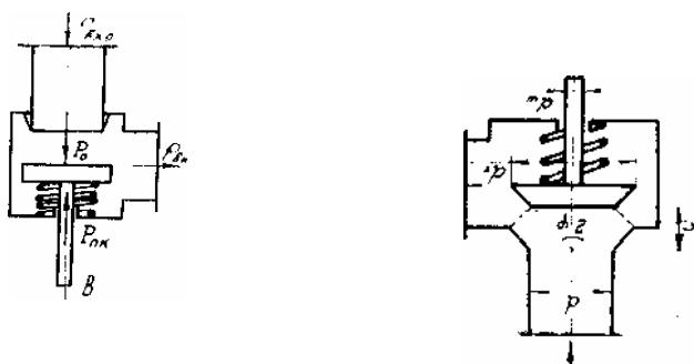
Рис. 2.2. Основные размеры клапана (а) и усилия, действующие на тарель
