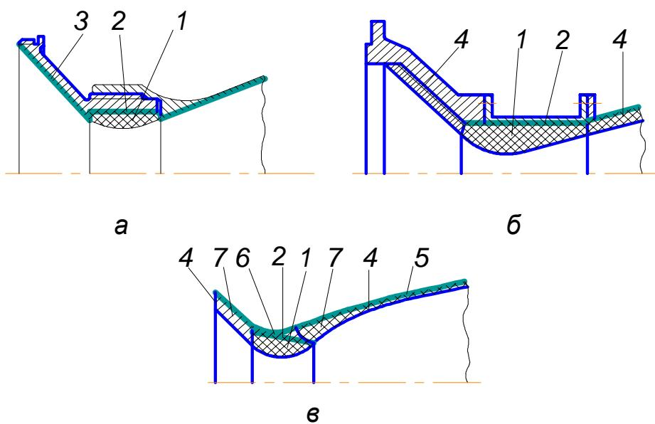
. Рис.4.12. Составные сопла: а – с металлической несущей конструкцией и теплоизоляционным покрытием; б – то же, с абляционным покрытием; в – со стеклопластиковой несущей конструкцией и абляционным покрытием: 1- вкладыш; 2 – теплоизоляция вкладыша; 3 – теплоизоляционное покрытие; 5 – абляционное покрытие; 6 – металлическая закладная деталь; 7 – направление слоев покрытия
