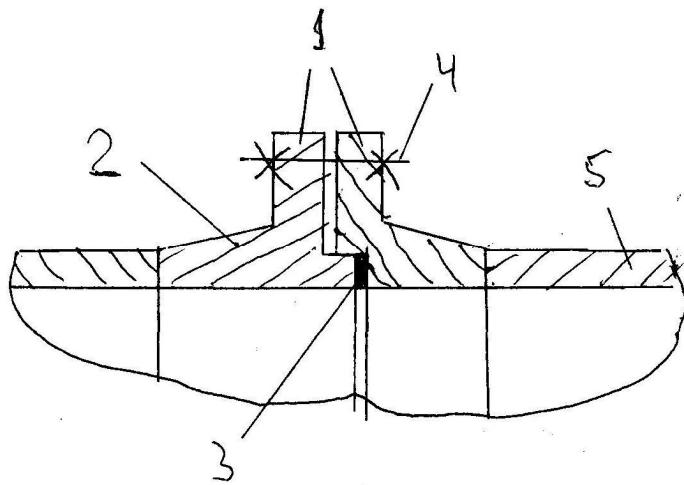
Рис.2.5. Фланцевое соединение: 1 – фланец; 2 – втулка фланца;
