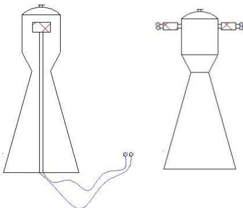
Рис. 1.9. Две схемы пиротехнического зажигания
