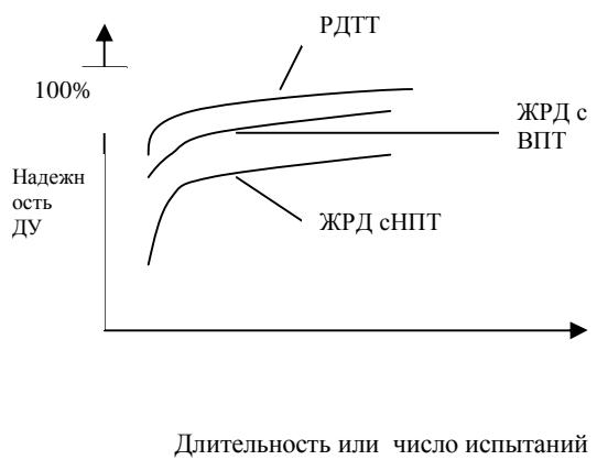
Рис.4.1. Зависимость надежности ДУ от числа летных испытаний в процессе обработки.
