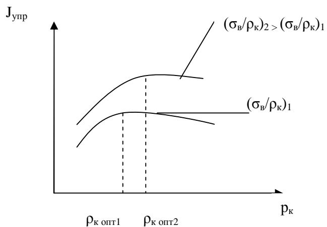
Рис.4.3. Зависимость приведенного удельного импульса от давления в камере
