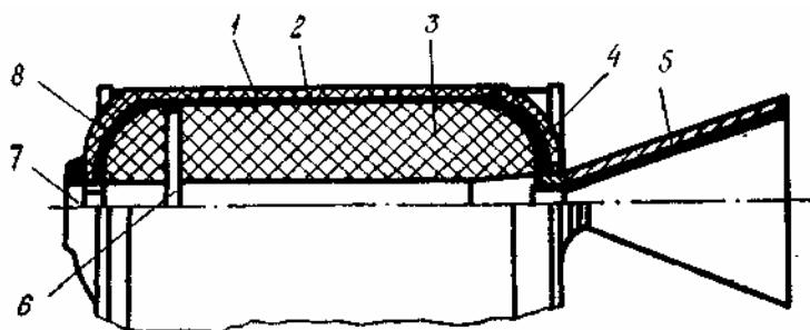
Рис. 4.5. Схема РДТТ со скрепленным зарядом: 1 — корпус из стеклопластика; 2 — теплоизоляция; 3 — заряд; 4 — заднее днище; 5 — сопло; 6 — поперечная прорезь; 7 — воспламенитель; 8 — переднее днище
