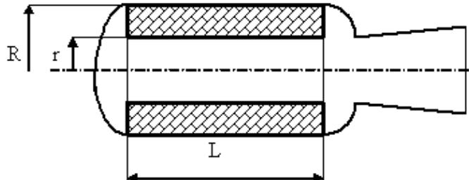
Рис.4. 14. Расчетная схема скреплённого заряда
