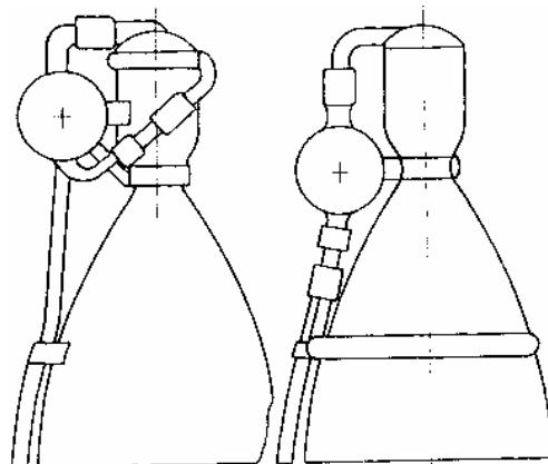
Рис.3.4. Компоновка ЖРД без дожигания:
