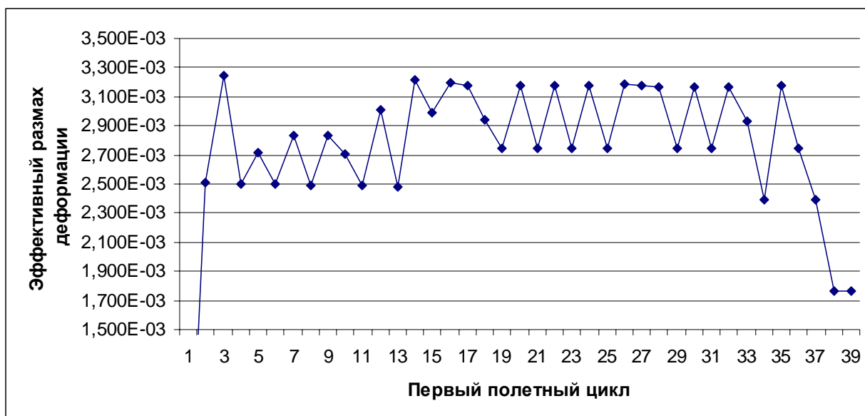
Рис. 18. Изменение полной деформации по циклам нагружения двигателя
