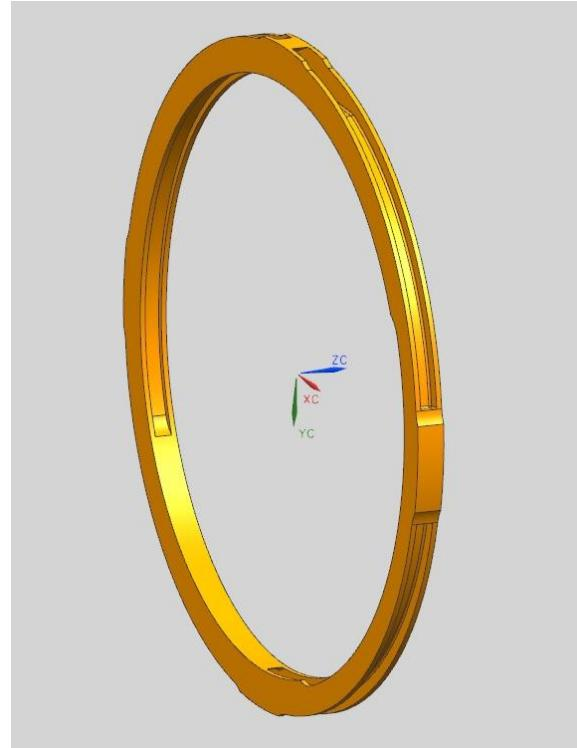
Рисунок 1.20 – Модель кольца с двумя захватами
